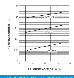
FIG. 2-TYPICAL REVERSE CHARACTERISTICS
