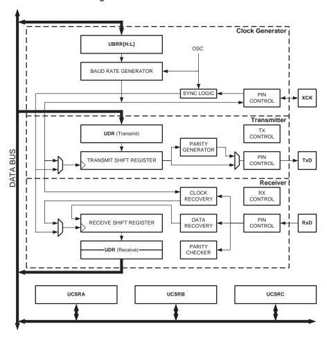
Figure 20-1. USART Block Diagram<sup>(1)</sup>
